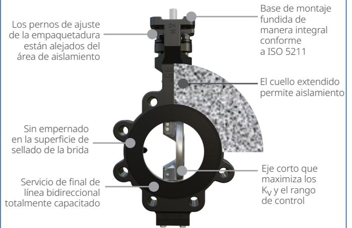
**Simplifique sus activos de válvulas** con una solución diseñada para adaptarse a su planta química. La válvula tipo oreja proporciona un servicio de final de línea bidireccional totalmente capacitado con una superficie de sellado de brida ininterrumpida que cumple con la norma EN 12569. La válvula está diseñada según las especificaciones de NAMUR NE 167, ISO y EN con certificaciones PED y CE de forma estándar.
