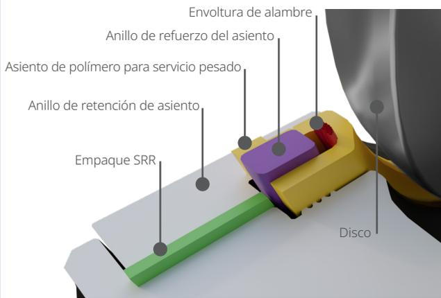
**Implemente el diseño de asiento K-LOK probado** que suministra un cierre de cero fugas conforme a EN 12266, independiente de la presión en la tubería. El diseño elimina casi todos los vacíos y, con ellos, la posibilidad de que se acumule el medio. Esto permite que la válvula ofrezca el mismo rendimiento de sellado superior a una presión muy baja, y en servicios exigentes que contienen partículas.
