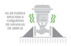
Comprobación de vibraciones Con dos sistemas de vibración electrodinámicos, medimos la capacidad de un producto para soportar vibraciones extremas que pueden alcanzar hasta 4500 libras (2041 kilogramos) de fuerza.
