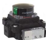
Переключательные блоки TopWorx™ серии T обладают исключительной ценностью, обеспечивая полный набор функциональных возможностей в компактных корпусах для непосредственного монтажа. Изделия серии T имеют разнообразные варианты первичных преобразователей положения, встроенных электромагнитных клапанов и устройств сопряжения с шинами, что делает их пригодными для использования во всех опасных зонах. Изделия имеют сертификаты IECEx, ATEX и CSA.
