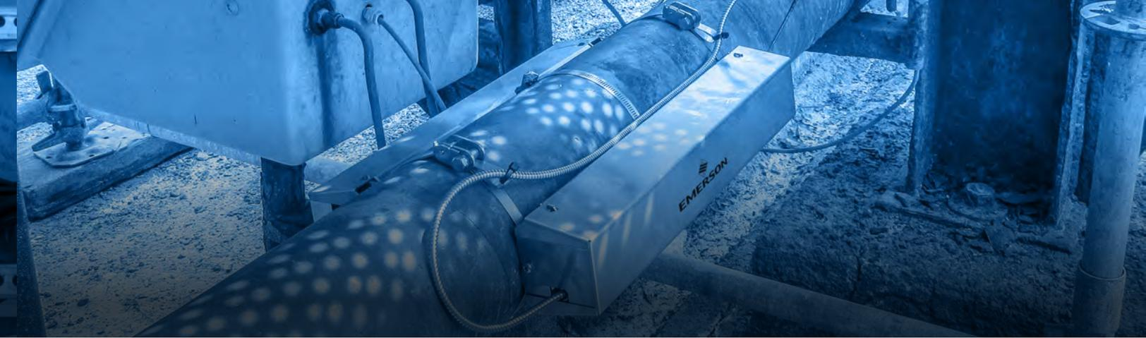
In vielen binären Fluidsystemen steht die Schallgeschwindigkeit in einem festen Verhältnis zu Konzentration und Dichte. PIOX® S verfügt über eine umfangreiche Stoffdatenbank und kann somit in Echtzeit präzise und zuverlässig die Dichte, Konzentration und den Massenstrom zahlreicher Säuren, Laugen und anderer chemischer Fluide bestimmen.
