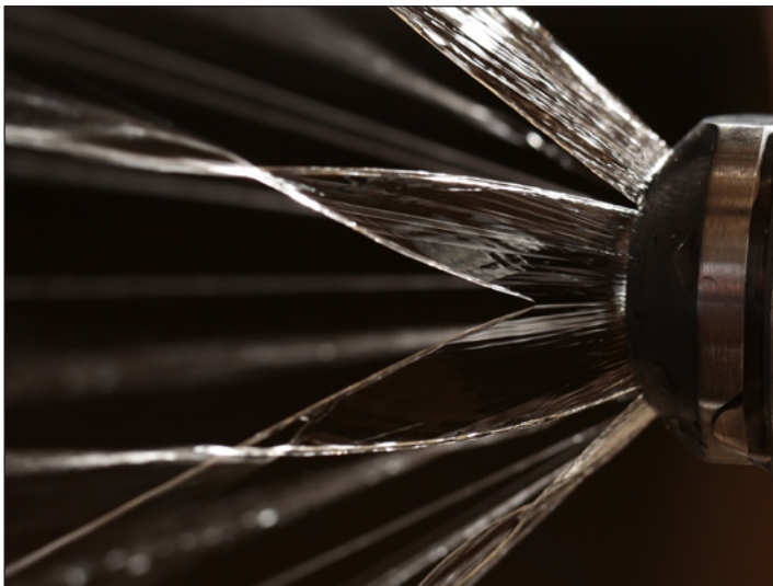
Patrón de atomización de una boquilla dañada de atomización atomizado mecánicamente.
