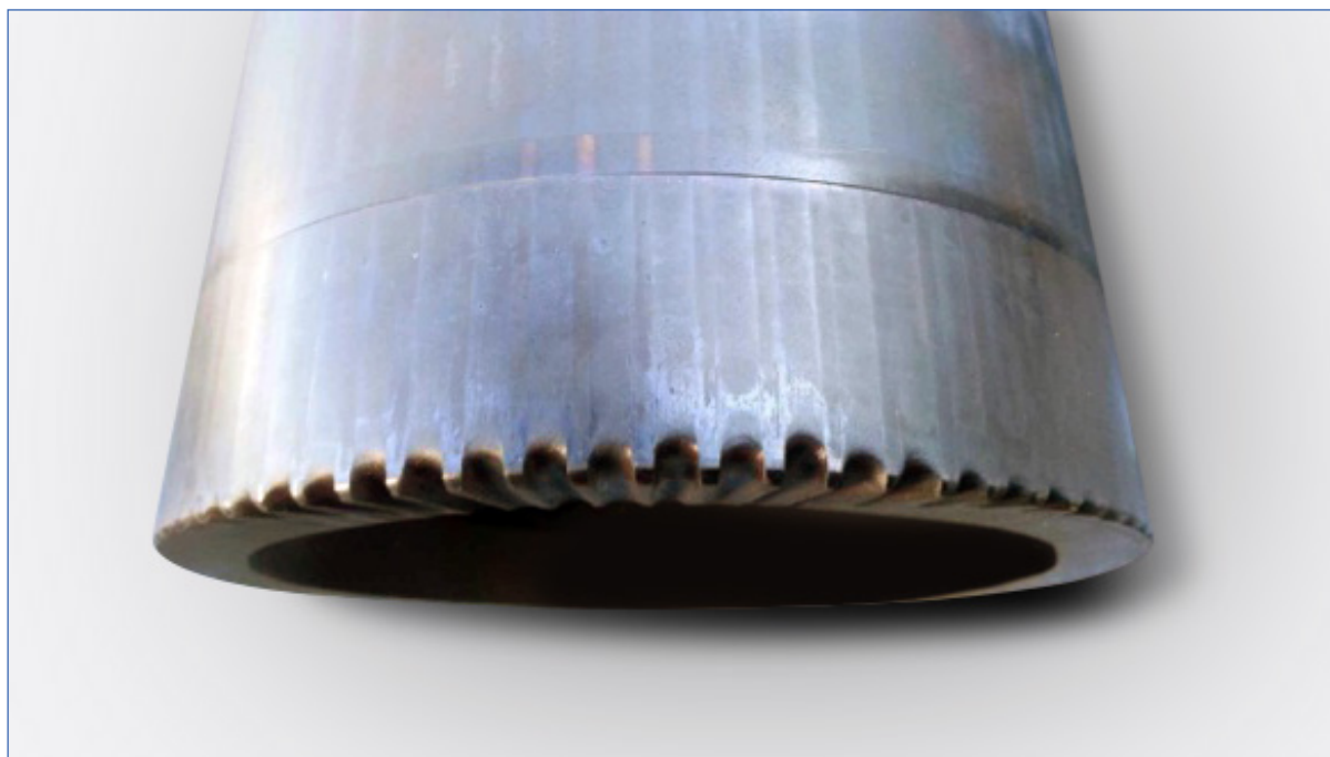
Daño en el tapón de la válvula de control provocado por una fuga de vapor mientras estaba cerrado.
