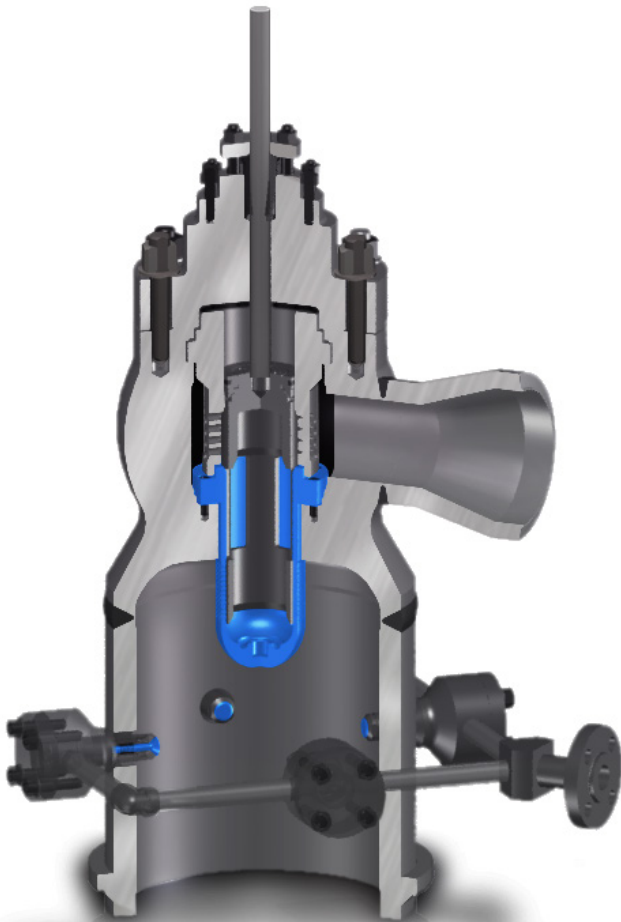
La válvula de control Fisher TBX con regulador con supresión de ruido ayuda a evitar problemas relacionados con el ruido y la vibración.
