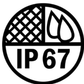
La **classificazione IP67** (a tenuta di polvere e con immersione in acqua fino a 1 metro di profondità) consente l'installazione in ambienti più difficili.
