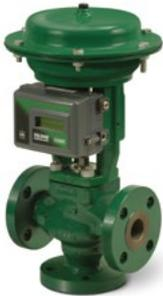
Las **válvulas de tres vías** son un tipo de válvula de globo que tiene tres conexiones de tuberías para proporcionar un servicio convergente (mezcla del flujo) o divergente (división del flujo). Las variantes incluyen diseños de jaula, lumbrera y guiados por vástago, que se eligen para servicio de alta temperatura, y conexiones finales estándar que se pueden especificar para su adaptación a la mayoría de configuraciones de tubería. ▶ [YD e YS](#) | [GX](#)
