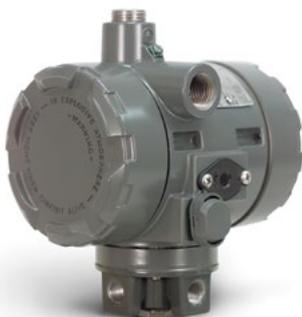
Los transductores electroneumáticos (I/P) convierten una señal electrónica en una señal neumática. Se utilizan de rutina en circuitos de control que requieren que una señal de control electrónico desde un controlador de lógica programable o un sistema de control distribuido sea convertida en una señal neumática utilizable para el funcionamiento de una válvula de control. ▶ i2P-100 | 646 | 846
