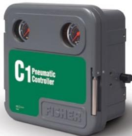
Los controladores neumáticos son dispositivos mecánicos que están diseñados para medir la temperatura o la presión y transmitir una señal de aire correctora al elemento de control final. Como elementos de detección se utilizan tubos Bourdon, fuelles, elementos térmicos o desplazadores. El suministro de potencia y la salida de un controlador neumático puede ser aire comprimido o gas natural. ▶ C1 | 4194 | 4195K | 4196 | 4660
