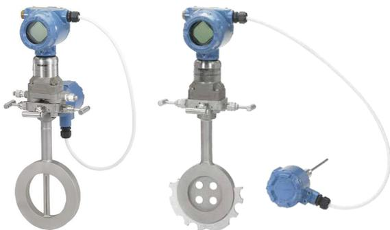
Семейство расходомеров дифференциального давления Rosemount 3051SF является точным и простым в установке решением для измерения перепада давления в инженерных сетях. Расходомеры данного семейства могут оснащаться стабилизирующей диафрагмой для использования в трубопроводах с ограниченными прямыми участками или первичным элементом Annubar™ для снижения потерь давления и идеально подходят для применения в пивоваренном производстве.
