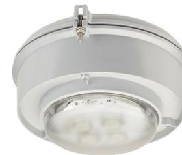
Диодные светильники серии Appleton Mercmaster с малым вертикальным размером отличаются легкой компактной конструкцией и подходят для установки на небольшой высоте. Шесть стандартных вариантов конструкции крепежного кронштейна позволяют устанавливать светильники где угодно, а благодаря четырем вариантам исполнения плафонов — прозрачный и матовый поликарбонат, прозрачное стекло и стеклянная призма — вы сможете подобрать светильник под любые требования.
