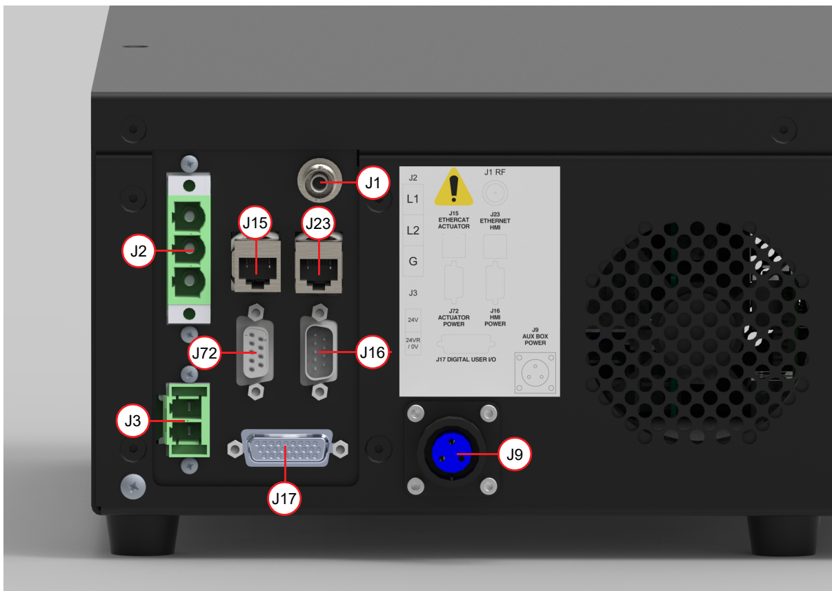
Abbildung 4.6 Anschlussstellen für Kabel des GSX-Generators
