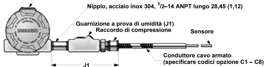
Non disponibile per i sensori serie 58C, 68Q e 183 o con certificazione a prova di esplosione FM o CSA, o con certificazione a prova di fiamma IECEx o ATEX/ISSEp (codici opzione E5, E6, E7 o E1).
