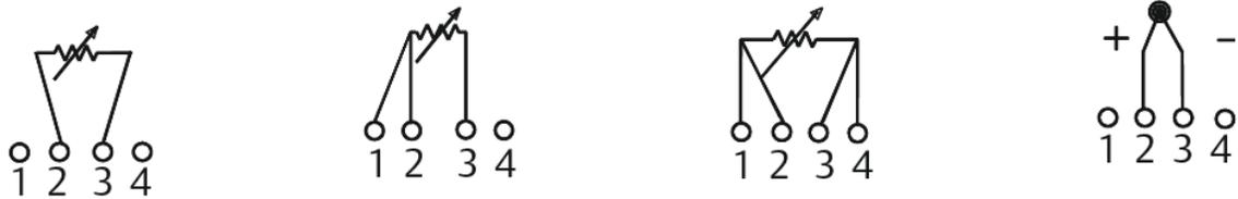
Termoresistenza RTD a due fili e  $\Omega^{(1)}$     Termoresistenza a 3 fili e  $\Omega^{(1)}$     Termoresistenza a 4 fili e  $\Omega$     Termocoppia e mV
