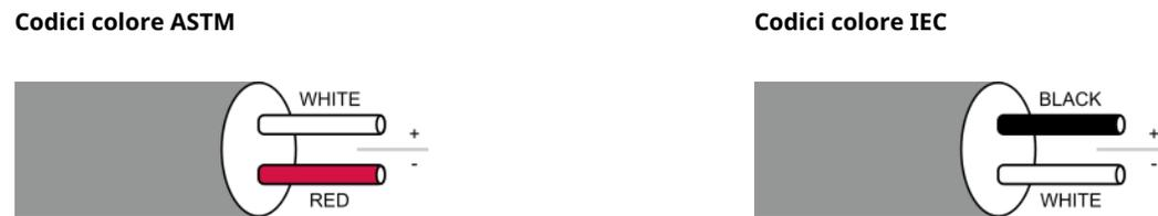
Realizzate in ferro e costantana, le termocoppie Tipo J presentano un campo di temperatura potenziale compreso tra -40 e 1.400 °F (tra -40 e 760 °C) e una sensibilità di circa 50 µV/°C. Le termocoppie Tipo J diventano fragili al di sotto di 32 °F (0 °C) e sono adatte per l'uso nel vuoto e in atmosfere riducenti o inerti. Queste termocoppie hanno una durata ridotta se utilizzate in atmosfera ossidante.
