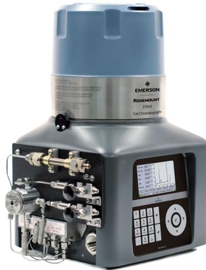
Il gascromatografo per gas naturale (GC) Rosemount 370XA, parte della serie XA di gascromatografi Emerson, è progettato per offrire semplicità di utilizzo e prestazioni di misurazione superiori per analisi C6+ e C7+ BTU/CV.
