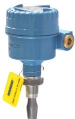
L'interruttore di livello Rosemount 2120 fornisce un rilevamento e controllo di livello facile da installare e affidabile. La certificazione di 3e parti IEC61508 (SIL2) di sicurezza e sanitaria, insieme alla scelta di output, lo rende idoneo a una vasta gamma di applicazioni. Non ha parti in movimento, non ha necessità di taratura e praticamente non viene influenzato dalle condizioni del processo. Il ritardo di commutazione regolabile previene false commutazioni in applicazioni turbolente.
