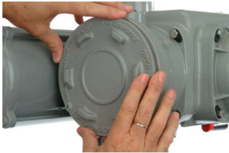
Figure 8 Enlever le couvercle STC en le faisant tourner dans le sens antihoraire
