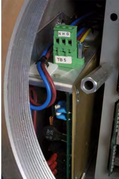
Zum Entfernen und Austauschen der AC/DC-Spannungsversorgung ist ein Kreuzschlitzschraubendreher der Größe 2 erforderlich.
