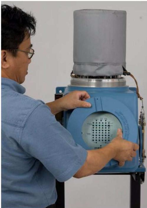
3. Entfernen Sie die Schalttafel oder das Bedieninterface, um Zugriff auf das Platinengehäuse zu
