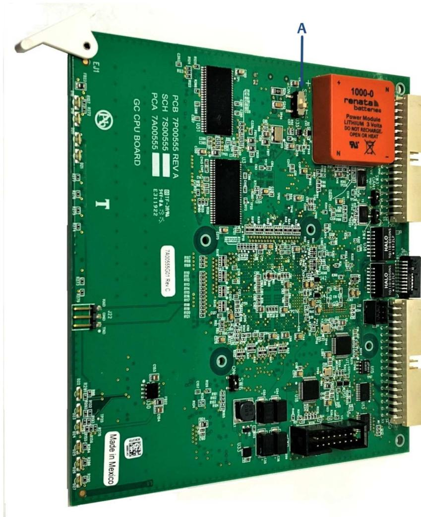
A. SW7-Schalter (Position ON liegt in Richtung des Punktes)
