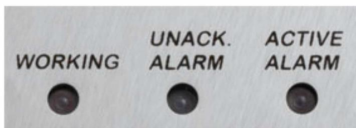
Die Schalttafel enthält auch die folgenden Statusleuchten, mit denen Sie den Zustand des GC überwachen können:
