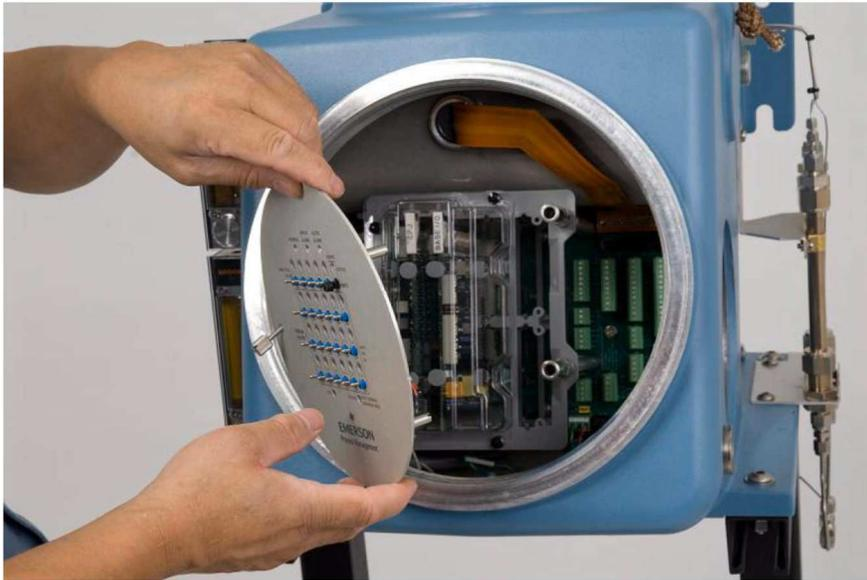
4. Sofern ein transparenter Gehäusedeckel vorhanden ist, entfernen Sie diesen vom Platinengehäuse.
