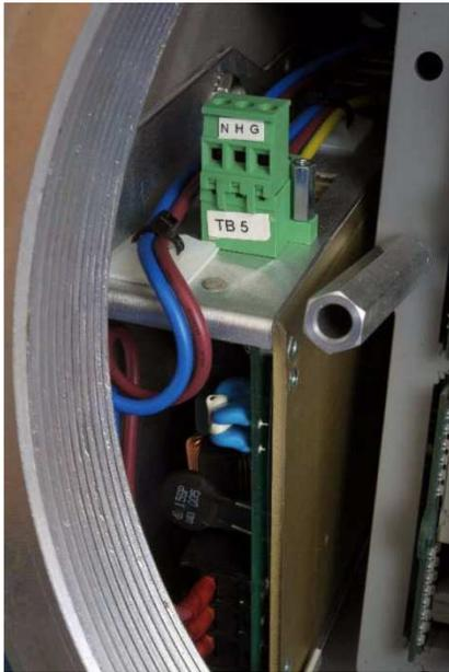
Zum Entfernen und Austauschen des Netzteils ist ein Kreuzschlitzschraubendreher der Größe 2 erforderlich.
