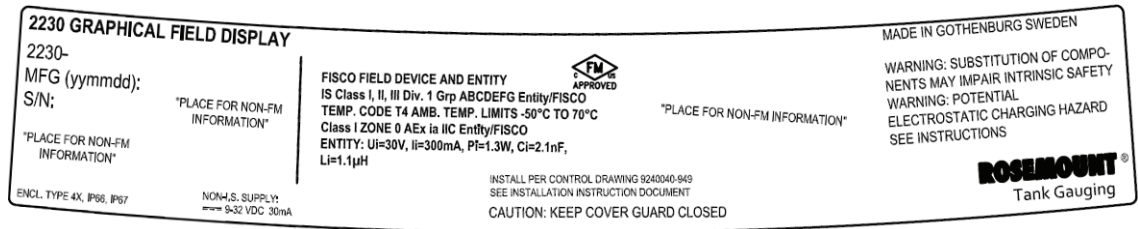
Abbildung B-1. FM-Eigensicherheit, US-Zulassungsschild
