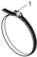
Abb. 7.26: Spannband mit Spannschloss
