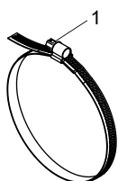
Abb. 7.51: Spannband mit Spannschellenschloss
