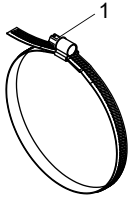
Abb. 6.33: Spannband mit Spannschloss
