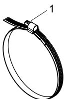
Abb. 6.58: Spannband mit Spannschellenschloss
