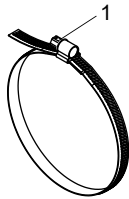
Abb. 6.23: Spannband mit Spannschloss
