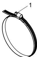
Abb. 6.48: Spannband mit Spannschellenschloss
