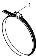
Abb. 6.50: Spannband mit Spannschellenschloss
