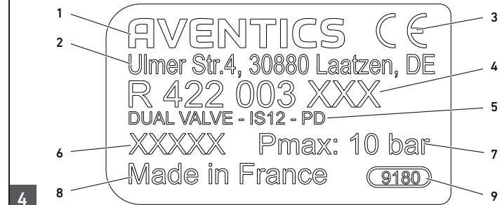
Typenschild | Plaque signalétique | Name plate | Targhetta dati | Placa de características | Typskylt 1: Firmenname | nom de la société | Company name | nome azienda | Nombre de la empresa | Tillverkarnamn 2: Firmenadresse | adresse de la société | Company address | indirizzo azienda | Dirección de la empresa | Tillverkarens adress 3: CE-Kennzeichnung | marquage CE | CE mark | marchio CE | Marcado CE | CE-märkning 4: Materialnummer | référence | Material number | codice | Número de material | Materialnummer 5: Typenbezeichnung | Désignation | Type designation | denominazione del tipo | Denominación de tipo | Typbeteckning 6: Fertigungsdatum | date de fabrication | Production date | data di produzione | Fecha de fabricación | Tillverkningsdatum 7: Maximaldruck | pression maximale | Maximum pressure | pressione massima | Presión máxima | Maximalt tryck 8: Herstellungsland | pays de fabrication | Country of manufacture | paese di produzione | País de fabricación | Tillverkningsland 9: Verantwortliches Werk | usine responsable | Responsible plant | stabilimento responsabile | Fábrica responsable | Ansvarig fabrik
