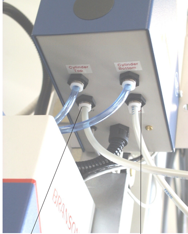
Şekil 5-21 aodm pnömatik ünitesi, alttan görünüm
