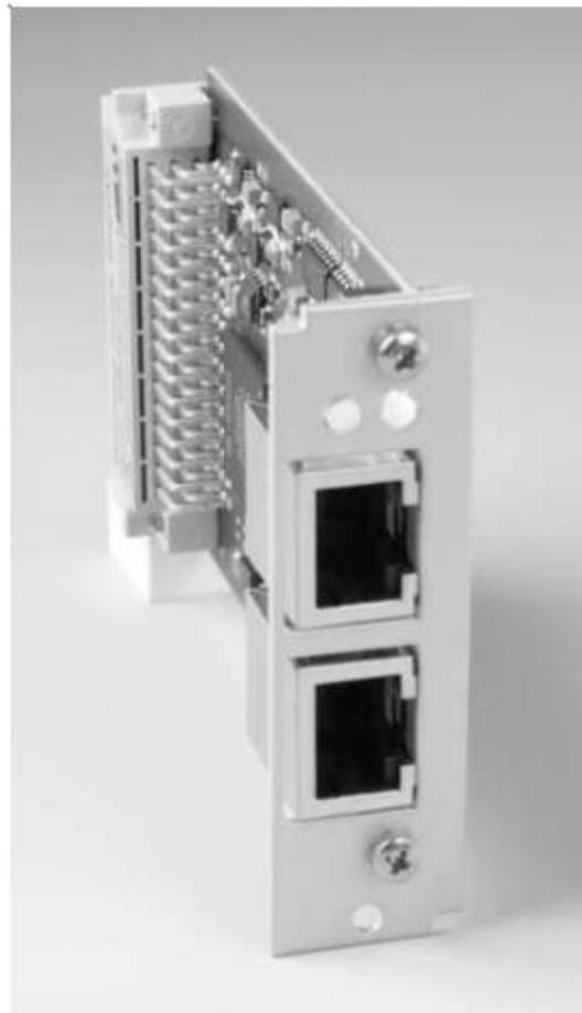
Abbildung 32: SE-Power EtherCAT-Interface: Ansicht vorne
