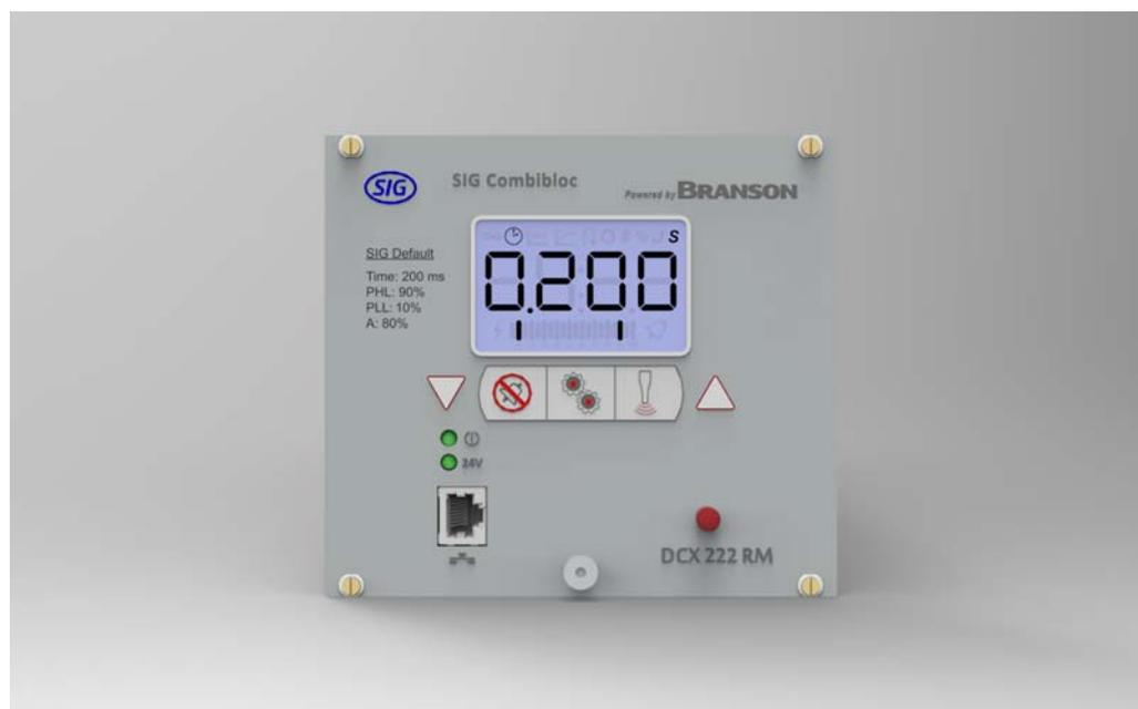
Der Generator DCX 222 RM SIG erzeugt über einen Ultraschallkonverter Ultraschallenergie für das Schweißen von Kunststoff. Es ist ein Modell mit einer Frequenz von 20 kHz und einem Leistungsbereich von 2,2 kW verfügbar. Der Generator umfasst auch ein mikroprozessorbasiertes Steuermodul zur Steuerung und Überwachung der Schweißarbeiten.
