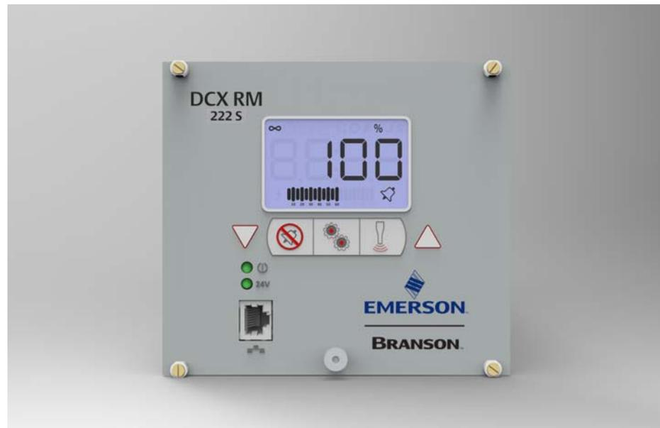
Der Generator DCX RM S erzeugt über einen Ultraschallkonverter Ultraschallenergie für das Schweißen von Kunststoff. Je nach gewünschter Frequenz (z. B. 20 kHz) und dem gewünschten Leistungsspektrum (z. B. 4,0 kW) stehen verschiedene Modelle zur Verfügung. Der Generator umfasst auch ein mikroprozessorbasiertes Steuermodul zur Steuerung und Überwachung der Schweißarbeiten.
