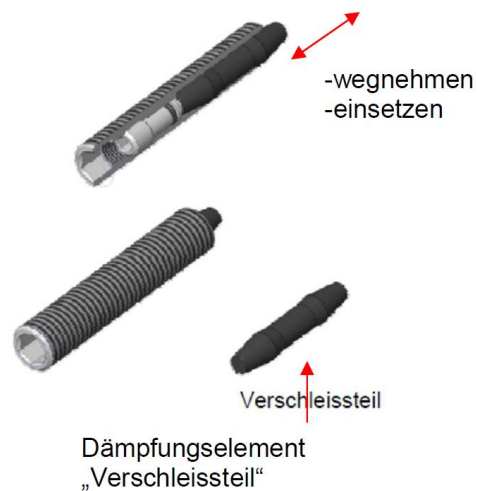
Abb. 26 Austausch der Dämpfungselemente (Elastomer-Stossdämpfer)
