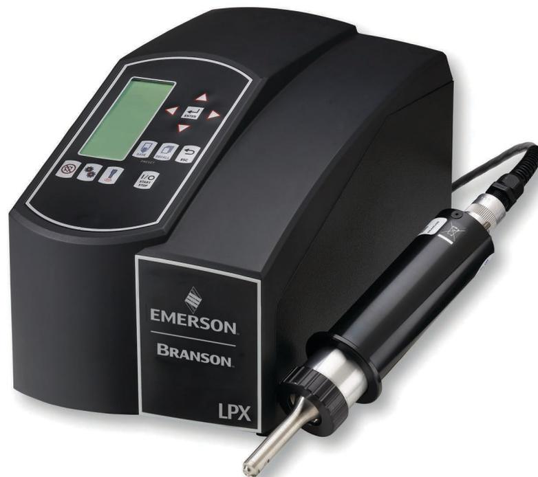
Der LPX Generator arbeitet mit konstanter Amplitude. Wenn Last oder Druck an der Sonotrodenoberfläche zunehmen, erhöht der Generator seine Ausgangsleistung, um weiterhin die vorgegebene Amplitude zu erreichen. Wenn die Sonotrode unbelastet in Luft schwingt, lässt sich die Amplitude mit minimaler Leistung aufrechterhalten.
