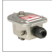
TYPE 08 : Métallique, revêtement époxy / Acier inox, AISI 316L WP / WS : CEI 335 EM / WSEM : EN/CEI 60079-7+18+31
