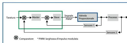
Il controllo a cascata contribuisce ad aumentare significativamente la qualità del processo, compensando tutti i fattori di impatto e i disturbi nella catena di controllo. La valvola gestisce tutte le variabili fisiche che possono essere influenzate dall'aria o da un attuatore.
