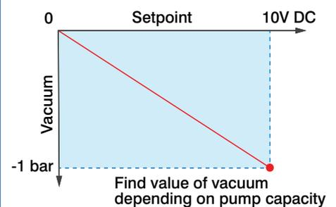
Adatto per applicazioni di controllo di pressione e vuoto, quali test di resistenza delle tubazioni o amplificatori di freni per auto.
