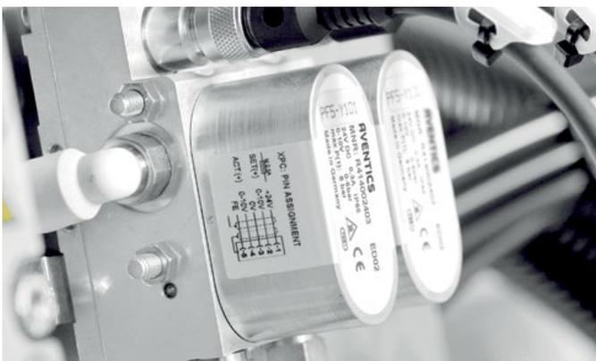
Die Proportionaltechnik ersetzt Ein-/Aus-Steuengeräte, die größere Ventilblöcke benötigen. ► S. 11
