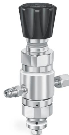
TESCOM 64-3400シリーズ・デュアルステージ超高純度減圧レギュレーターは、連結ダイアフラム型の設計で、表面処理は10 R<sub>a</sub>マイクロインチ / 0.25マイクロメートル、Hastelloy®トリムをオプションで選択できます。入口圧力は24.1 MPa / 3500 psig、出口圧力は最大1.03 MPa / 150 psigです。
