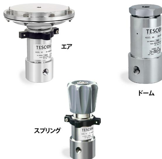
TESCOM 26-2000シリーズは、高圧力・低流量ピストン感知式圧力調整弁で、ロードタイプはドーム、スプリング、エアから選択できます。この圧力調整弁には、分離柄キャプチャーベントが標準装備されており、入口圧力定格は41.4-103 MPa / 6000-15,000 psigです。
