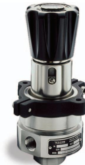
Die TESCOM-Serie 26-1600 bietet hochpräzise Druckregler mit Membransensorik und einstellbarer Sekundärentlüftung. Der Schalttafeleinbau, der integrierte 40-Mikron-Filter und das leichtgängige Handrad machen die Geräte besonders robust und anpassungsfähig, mit zahlreichen möglichen Modifikationen.
