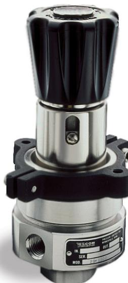
TESCOM 26-1600シリーズは、ベント基準を調整可能な高精度ダイアフラム感知減圧レギュレーターです。パネル取り付け型で、40ミクロンフィルターが搭載されており、低ハンドノブ作動トルクなので、頑丈で適応力の高い設計になっており、数多くの追加加工を施すことができます。
