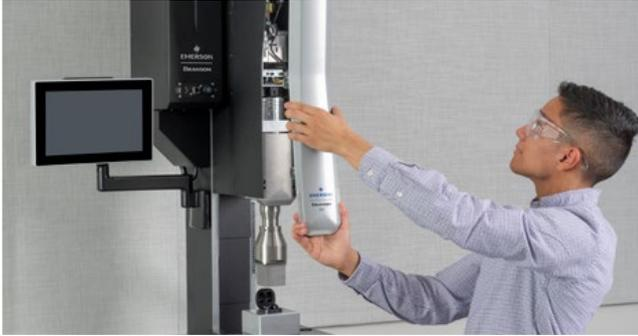
Branson GSX-Elite 정밀 시리즈에 탑재된 전기 기계식 첨단 구동 시스템은 실시간 피드백을 기반으로 즉시 조정할 수 있습니다. 이를 통해 광범위한 응용 분야 및 부품에 대한 정확도를 향상시킬 수 있습니다(폐쇄 루프).
