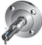
그림 2-5: 자유 스트림(weldolet 피팅) 방식 계기 설치
