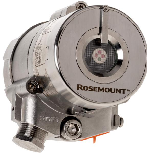
Rosemount 975HR 다중 스펙트럼 적외선 수소 화염 탐지기는 탄화수소 및 수소 화염을 감지하기 위해 특별히 설계되었습니다. 허위 경보에 가장 내성이 뛰어나고 원거리에서도 탄화수소 기반 연료 및 가스 화재를 탐지합니다. Rosemount 975HR은 시장에서 가장 내구성이 뛰어나며 날씨에 구애받지 않는 수소 화염 탐지기입니다. 응결이나 얼음을 없애주는 발열창, HART® 통신 프로토콜, 낮은 전력 요구 사항 및 컴팩트한 라이터 디자인 등이 특징입니다.
