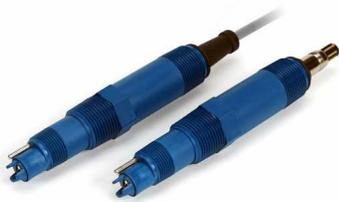
Rosemount 3900 및 3900VP 범용 pH/ORP 센서는 내화학 Ryton® 플라스틱 바디와 함께 고급 진단을 위한 솔루션 접지가 내장되어 있으며, 온도 보상을 위한 Pt-100 저항 온도 장치(RTD)가 적용된 제품입니다. 센서에는 일체형 케이블 연결 (Rosemount 3900) 또는 Variopol(VP8) 커넥터(Rosemount 3900VP)를 사용할 수 있습니다. Variopol 케이블은 별도로 판매됩니다(액세서리 참조).
