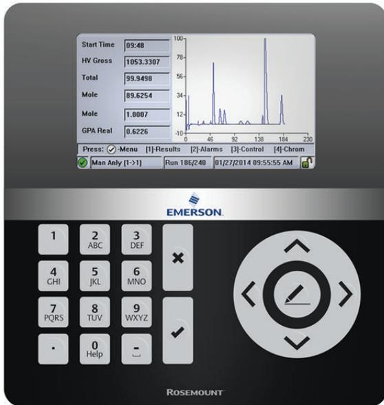
LOI에서 직접 대부분의 GC 일상 유지보수 기능을 수행할 수 있습니다. 대부분의 경우, 작업자들은 컴퓨터를 사용하지 않고 가스 크로마토그래프를 온라인으로 설치, 구성 및 배치할 수 있습니다.
