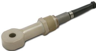
Rosemount 228 토로이달 전도도 센서는 내화학성 유리 충전 PEEK 또는 Tefzel™로 몰딩되었으며 산, 염기 및 염 용액의 농도를 측정하는 데 이상적입니다. 센서에는 온도 보상을 위한 일체형 PT-100 저항 온도 장치(RTD) 및 20피트(6.1m) 길이의 일체형 케이블이 있습니다. Rosemount 228은 다양한 삽입 장착 어댑터와 함께 사용하여 설치 요구 사항을 충족할 수 있습니다([액세서리 참조](#)).
