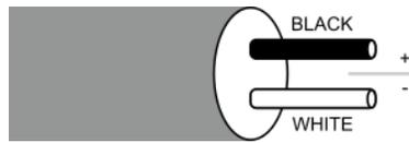
철과 콘스탄탄으로 구성된 유형 J 써모커플(Thermocouple)은 잠재적 온도 범위가 -40~1400°F(-40~760°C)이고, 민감도는 약 50µV/°C입니다. 유형 J 써모커플(Thermocouple)은 32°F(0°C)에서 깨지며 진공, 감압 또는 불활성 대기에서 사용하기에 적합합니다. 산화 대기에서 사용할 경우 이러한 써모커플(Thermocouple)은 수명이 짧아집니다.
