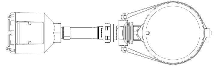
그림 8: Rosemount 연결 헤드가 포함된 파이프 클램프 센서 어셈블리
