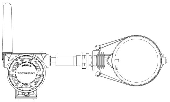
그림 10: Rosemount 648 무선 트랜스미터가 포함된 파이프 클램프 센서 어셈블리
