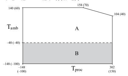
T<sub>amb</sub> = 주변 온도 °C T<sub>proc</sub> = 프로세스 온도 °C A = 사용 가능한 모든 전자부 옵션 B = 분리형 전자부 전용
