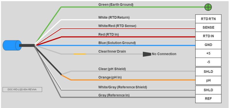
그림 3-5: Rosemount 1066 트랜스미터 배선의 전치 증폭기가 장착되지 않은 Rosemount 396P, 396PVP, 396RVP, 3300HTVP, 3400 HTVP, 3500P, 3500VP, 3900 또는 3900VP pH/ORP 센서
