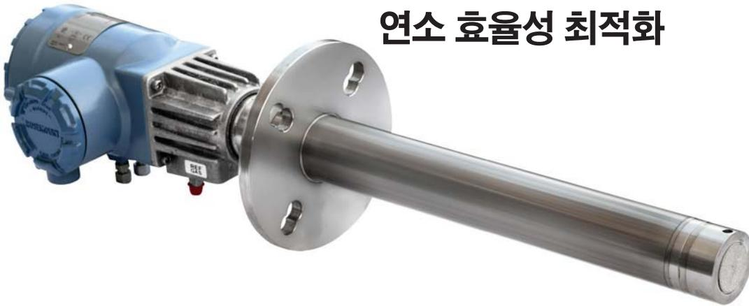
Rosemount Analytical 6888 In Situ Flue Gas Oxygen Analyzer(연도 가스 산소 분석기)의 새로운 통합 자동 검교정 성능은 유지보수 요구사항 감소 및 측정 정확성 향상을 도모한다. 에머슨 프로세스 매니지먼트가 연도 가스의 최적 산소 레벨 유지함으로써 대형 보일러 및 산업용 로(Furnace)의 연소 효율성을 최적화하기 위해, Rosemount Analytical 6888 In Situ Flue Gas O<sub>2</sub> Analyzer(연도 가스 산소 분석기)에 새로이 진단 성능을 강화했다.
