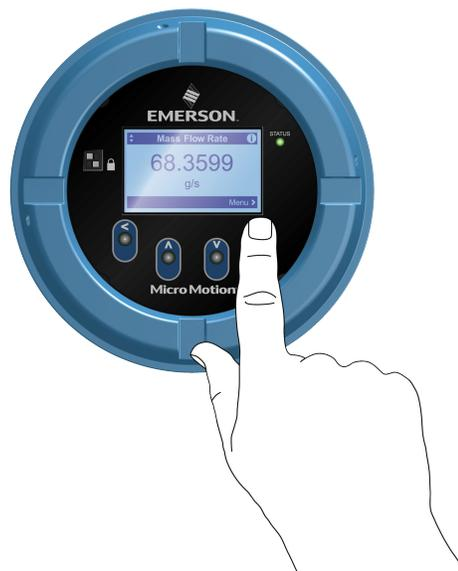
2. ディスプレイ上の矢印インジケータで、どの光学スイッチを使っているのかが分かります（例1と2を参照）。
