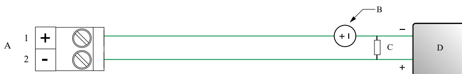
図 3-8 : mA/HART 出力の配線 (外部電源)
