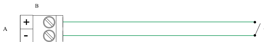
図 3-20: ディスクリート入力の配線 (内部電源)
