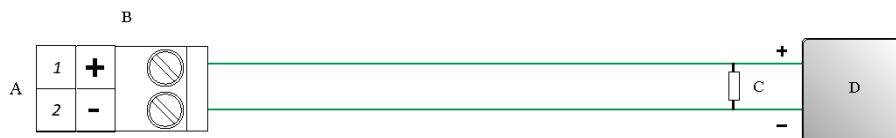
図 3-11 : 周波数出力の配線 (内部電源)
