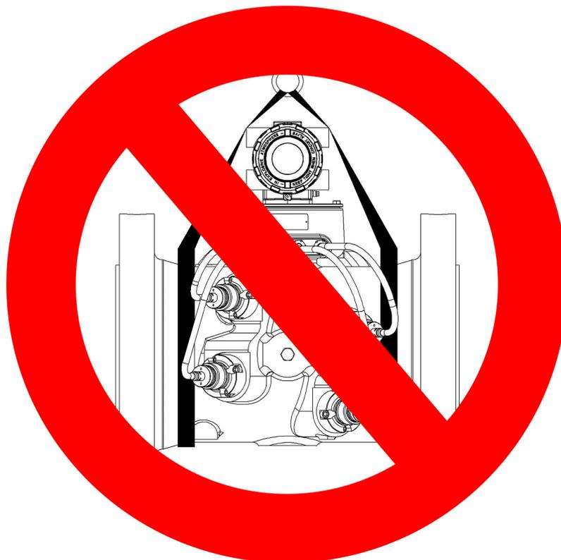
8. メータに衝撃荷重がかからないようにしてください。メータは少しずつ吊り上げてください。衝撃荷重が発生した場合は、その後稼働状態にする前に、メーカーの手順に従ってスリングを点検してください。
